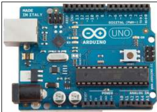
Figura 1. Módulo Arduino. Información tomada de página web learn.sparkfun.com . Elaborado por el autor.
