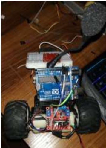
Figura 7. Circuito ensamblado en un carro de control remoto. Información tomada de la investigación. Elaborado por García Torres Ingrid.
